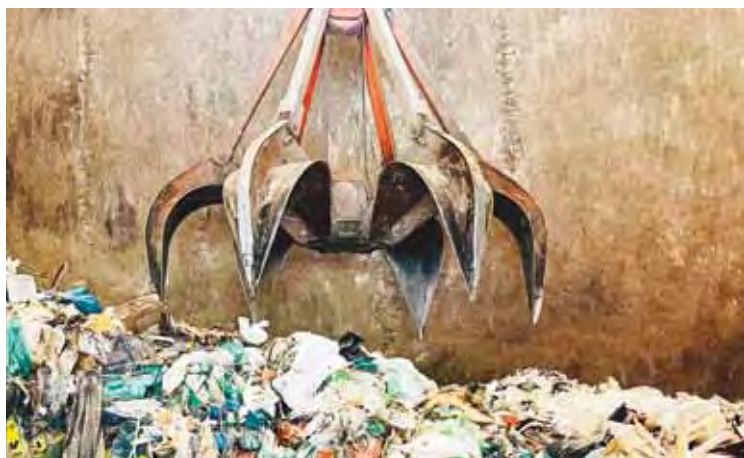
Restmülltonne und dann? Der Krangreifer füttert die gierigen Schlunde der drei Ofenlinien der MVA Ingolstadt – der Beginn der Energieerzeugung aus Abfall
